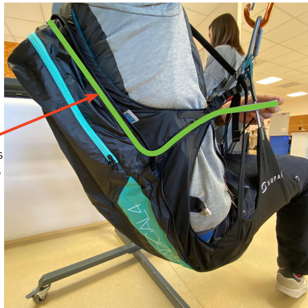
Cheminements des élévateurs
